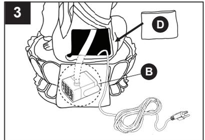
4. Remplissez le réservoir avec assez d'eau pour immerger la pompe (B) entièrement. Branchez le cordon d'alimentation sur une prise de courant pour mettre la fontaine en marche.
