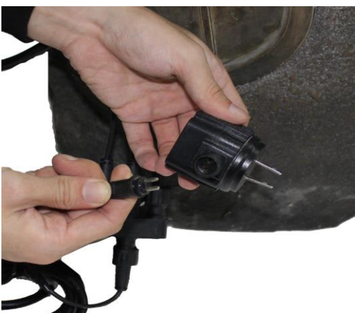
Fixez le cordon d'alimentation de l'éclairage au transformateur.
