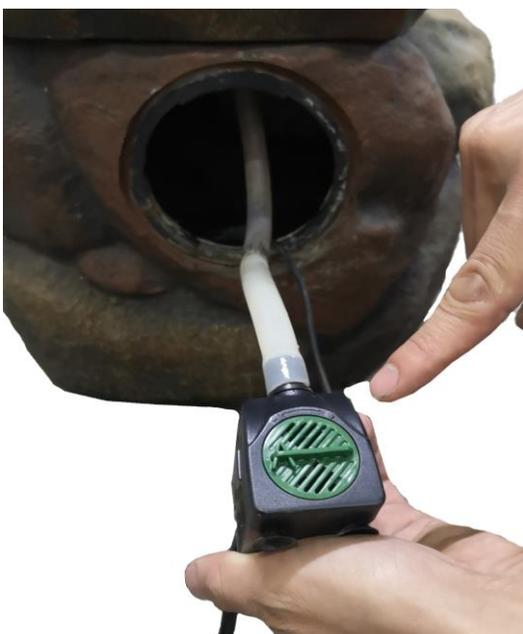
Prenez le tube et fixez-le à la pompe. Le débit d'eau peut être réglé à l'aide du cadran situé à l'avant de la pompe.
