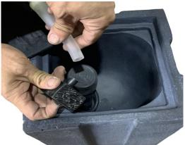
Trouvez le tube et attachez-le à la pompe. Le débit d'eau peut être réglé à l'aide du cadran situé à l'avant de la pompe.
