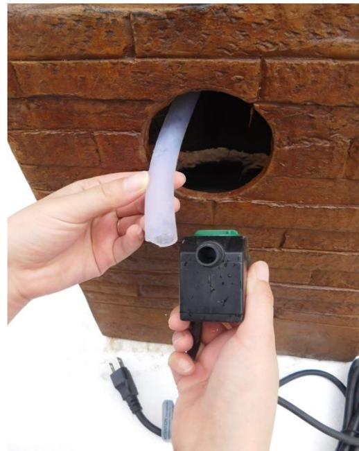
Trouvez le tube et attachez-le à la pompe. **Remarque:** le débit d'eau peut être ajusté à l'aide du cadran situé à l'avant de la pompe. Placez la pompe à l'intérieur de la fontaine.
