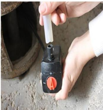
Raccorder le tuyau de la pompe, puis placer la pompe à l'intérieur du boîtier. Installez la porte d'accès de la pompe.
