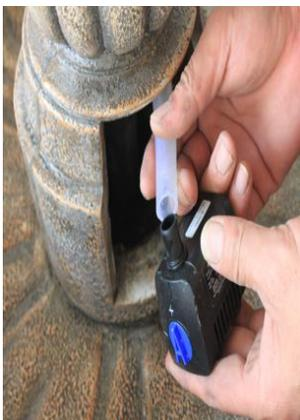
Connecter le tuyau à la pompe, puis placez la pompe à l'intérieur du boîtier. Installer la porte d'accès de pompe.
