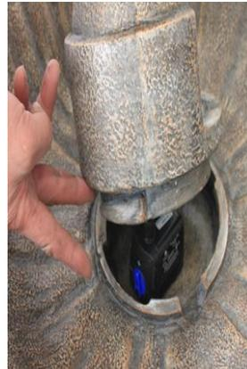
Ensemble, le corps de pompe en placer, aligner les rainures puis tordre et verrouillez-le dans le bol.
