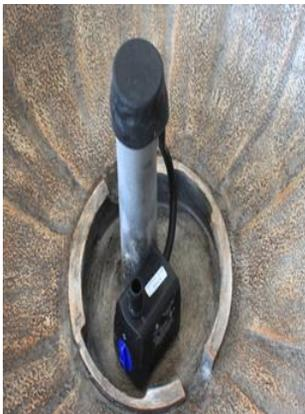
Installer le cache-câbles tuyau sur le tuyau du cordon tel qu'illustré.
