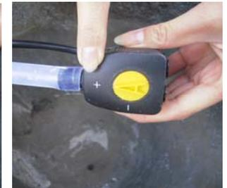
Ajustez le contrôle de flux comme nécessaire.
