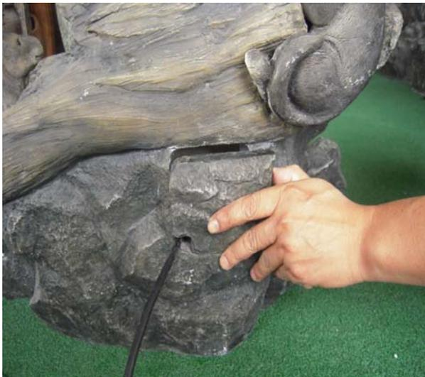
Placez l'appartement de pompe à l'intérieur du réservoir. Alignez la corde de pompe avec la cannelure et installez la porte d'accès de pompe.
