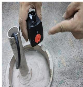
La pompe est pré-réglée à la pleine force. Si l'éclaboussure est un souci, ajustez comme nécessaire.
