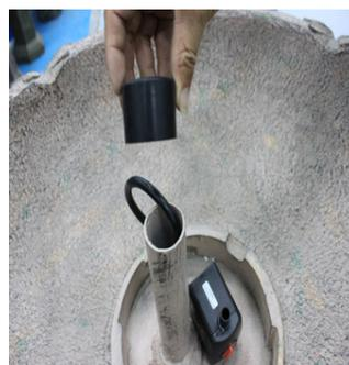
Installez la couverture de pipe de corde au-dessus de la pipe de corde. Attachez la tuyauterie à la pompe.
