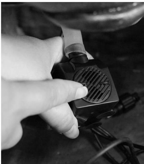
La pompe est réglée à la pleine force, ajuster au besoin. Placer la pompe à l'intérieur du réservoir. Tout excès de cordon peut être récupéré à l'arrière de la fontaine.
