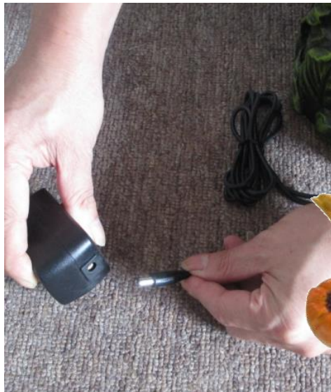
Attacher la plus longue corde de la pompe vers le transformateur comme indiqué ci-dessus.
