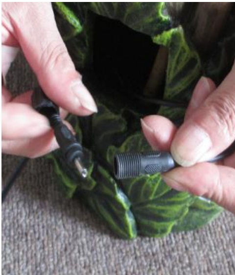
Trouvez et fixer le cordon d'alimentation des lumières (pré-installé) à la plus courte cordon d'alimentation de la pompe. Cette connexion doit rester en dehors de la fontaine.
