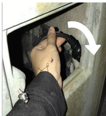
Passez le cordon de la pompe dans le canal du cordon (situé à droite de la porte de la pompe à l'intérieur de la fontaine).
