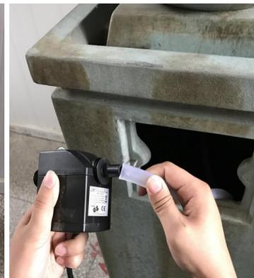
Trouvez le tuyau à travers la porte d'accès de la pompe. Fixez le tube à la pompe.
