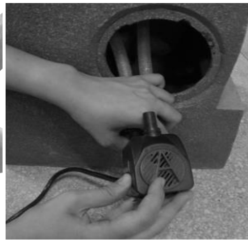
La pompe est pré réglée pour le réglage optimal. Régler le débit de l'eau au besoin en utilisant la molette.
