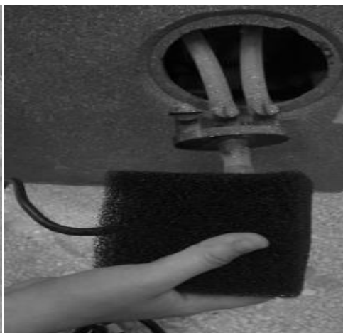
Trouver le tube de l'intérieur de la fontaine et l'attacher à la sortie de la pompe. Pour le débit d'eau à peaufiner, les contrôles peuvent être ajustés sur le déflecteur au besoin.
