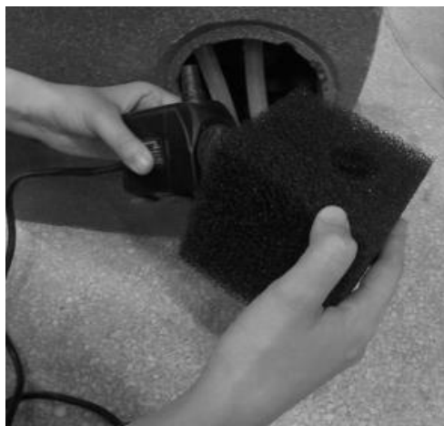
Insérez la pompe dans le filtre de la pompe Pumpjack™ inclus.
