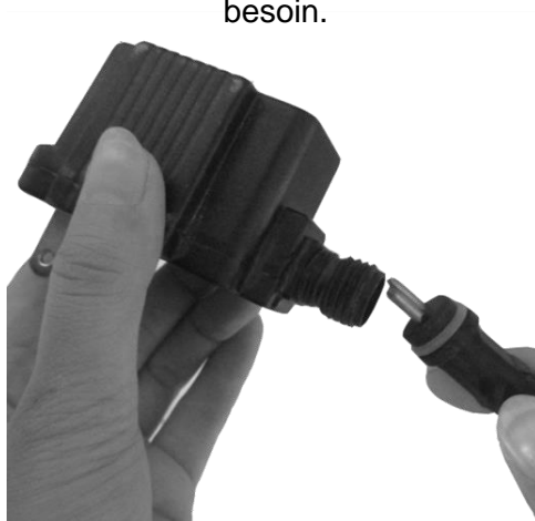
Fixez le cordon d'alimentation de l'éclairage au transformateur.
