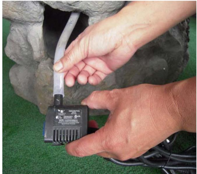
Trouvez la tuyauterie de l'intérieur de la fontaine et reliez-la à la pompe. La pompe est pré réglée à la pleine force, si l'éclaboussure est un souci ajustent le contrôle de flux comme nécessaire.
