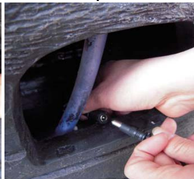
Trouvez le câble léger de l'arrière de la fontaine et reliez-le au câble correspondant de la pompe.
