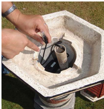
Placez la pompe et la lumière ci-jointe à l'intérieur du réservoir d'eau.
